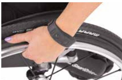
SmartDrive utilizza un controllo da polso bluetooth intelligente per la gestione del propulsore di spinta.
